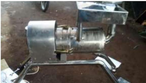
Gambar 1. Mesin pemisah biji dan daging buah nangka
